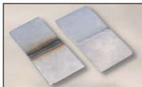
Izgled pred obdelavo in po njej z zelo majhno hrapavostjo na nerjavečem jeklu
